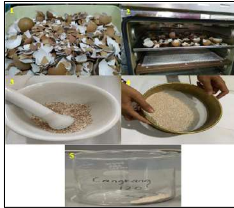
Gambar. 4. Pembuatan Adsorben Cangkang Telur
